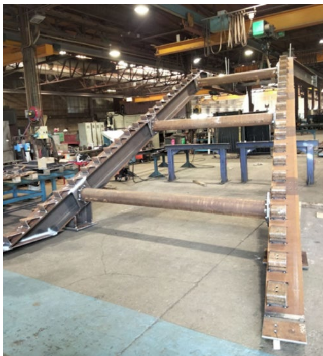
Montage à blanc de l'escalier Nord à gauche et du tablier à droite
