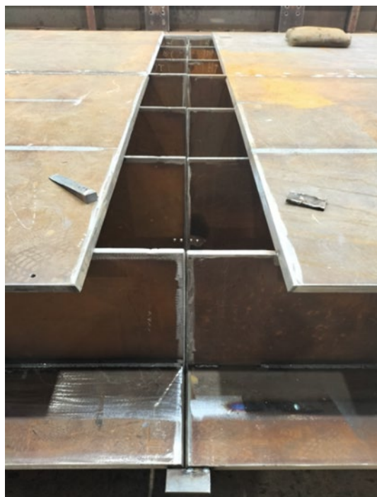
Montage à blanc de l'escalier Nord à gauche et du tablier à droite
