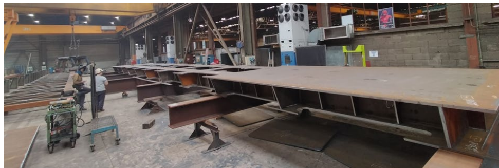
Construction des habillages intérieurs sur gabarit avant assemblage des poutres principales.
