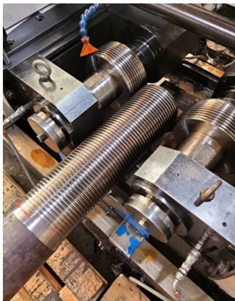
Image 7 : Filetage par roulage chez Bayonet
