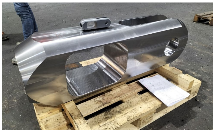
Image 6 : Chape inférieure n°1 lors de la réception chez l'usineur. Avec le prototype imprimé en 3D posé dessus
