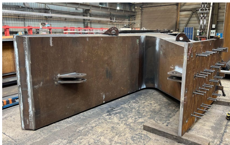
Pile architecturale en fin de fabrication dans les ateliers de BERTHOLD
